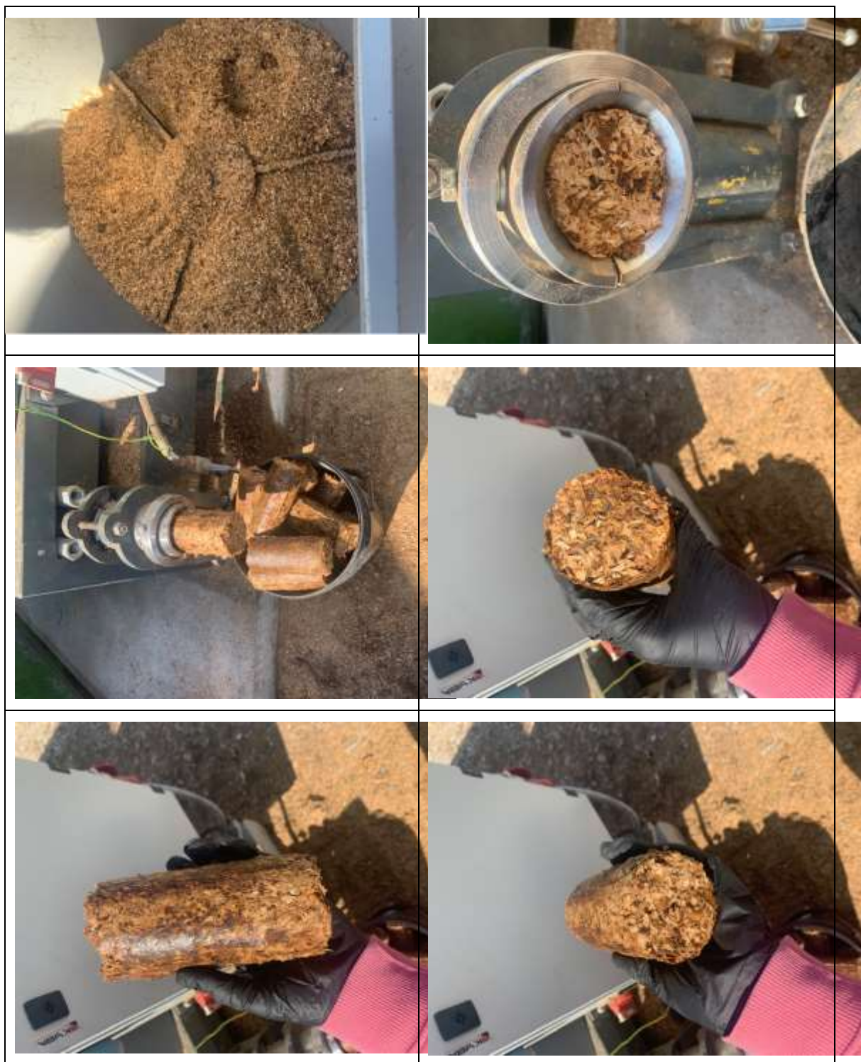
Εικόνα Β1. Διαδικασία μπρικετοποίησης με σκοπό την παραγωγή μπρικέτας από άχυρο (60%) και αποστειρωμένα τροφικά υπολλείματα_2019 (40%)
