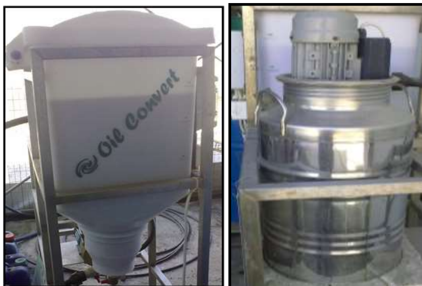
Εικόνα 2 Δοχείο Αποθήκευσης Ελαίου και Ανάμιξης μεθανόλης με καταλύτη
